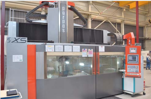
Alle Strukturen der Parpas XS 63 sind mittels einer zweiten Haut klimatisiert, alle internen Wärmequellen sind innengekühlt.
