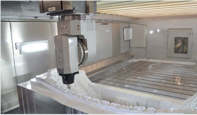
Schlanker Orthogonal-Kopf für tiefe Kavitäten mit kurzen stabilen Fräsern. Die Innenauskleidung der Maschine ist aus Edelstahl.
