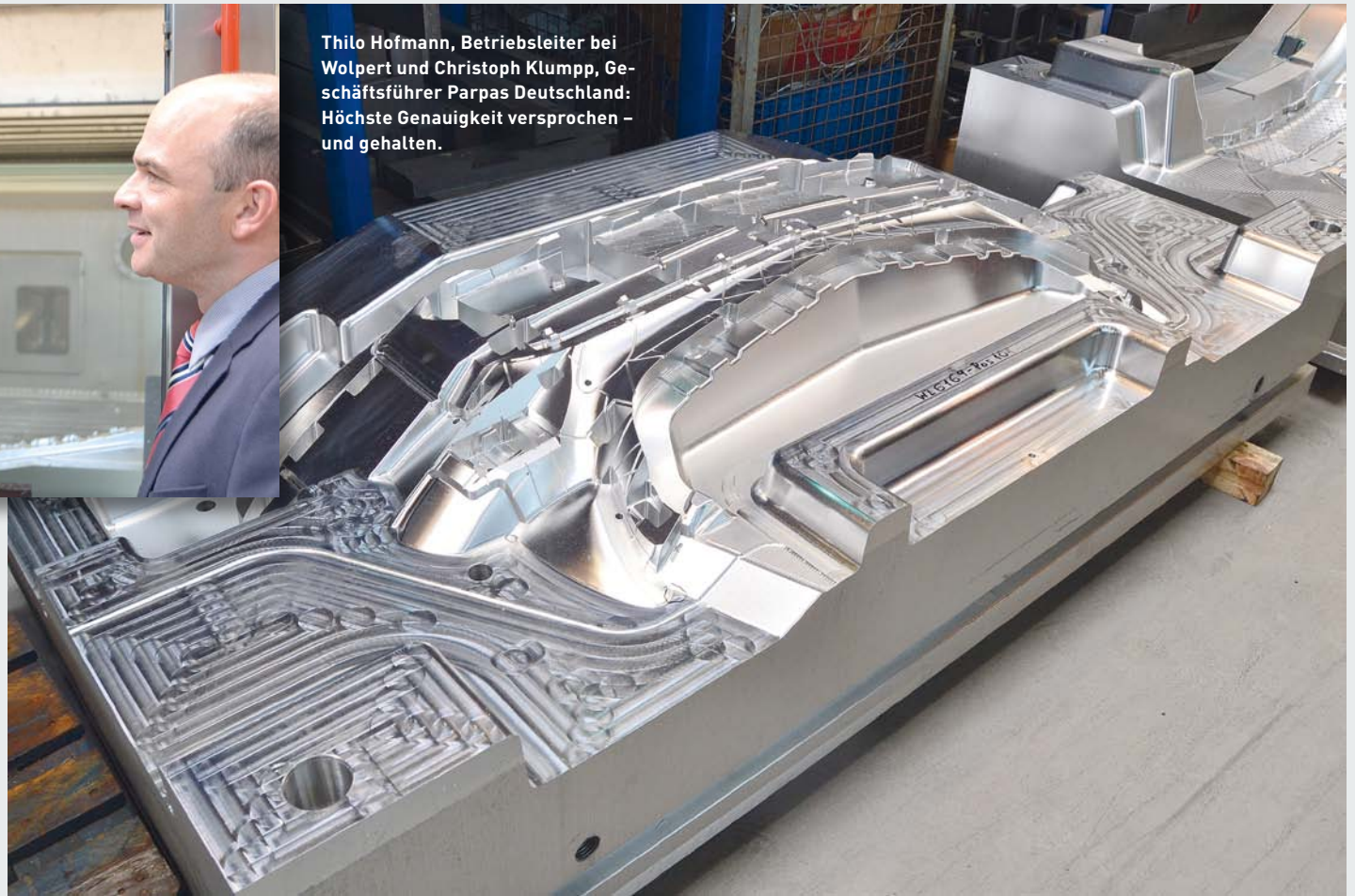
Zwei Formhälften für die Frontschürze eines Prototypen: Zwei-Meter-Form fünfachsig in Hundertstel-Genauigkeit gefräst.
